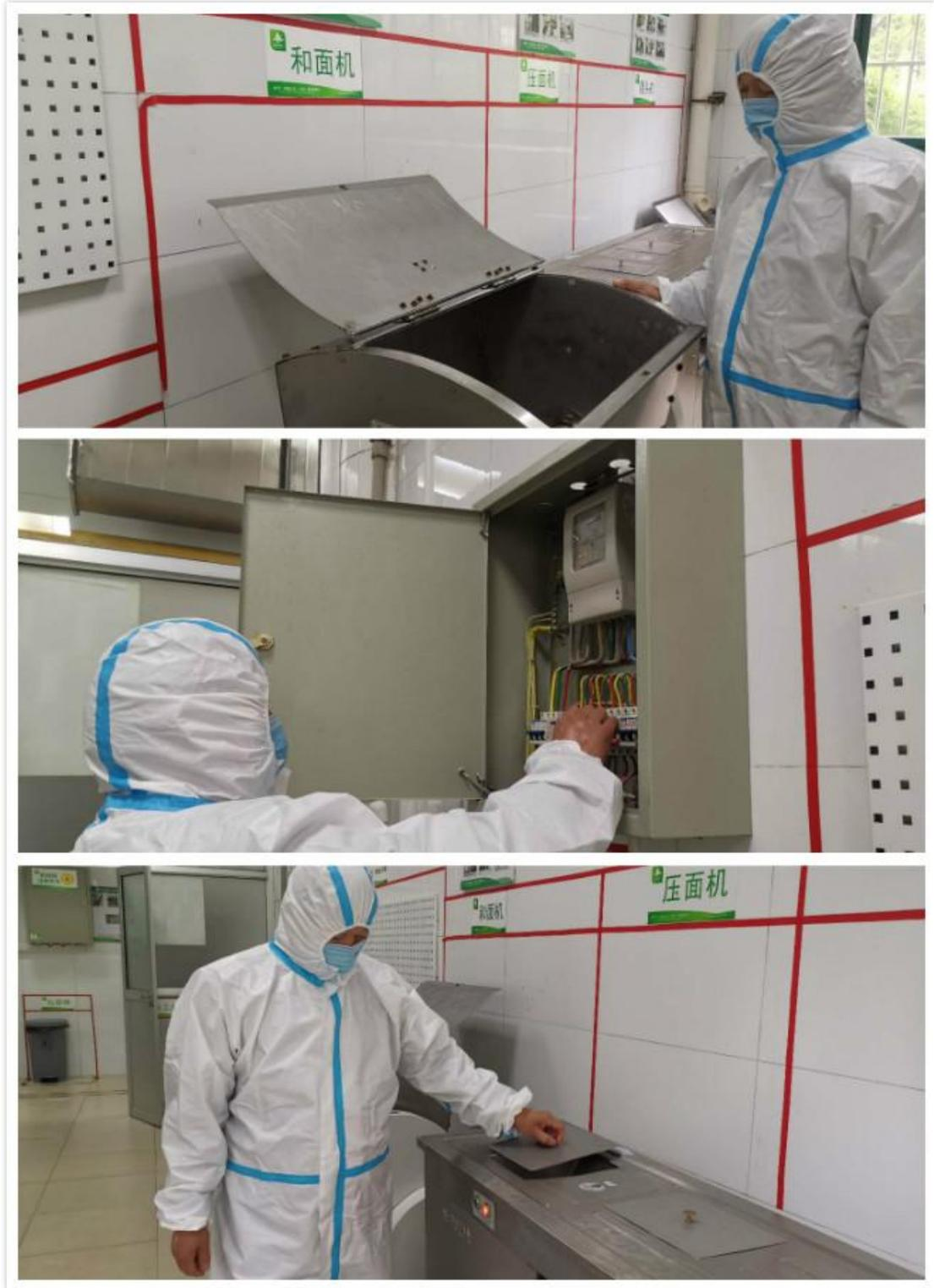
所有设备均拆开保鲜膜，并通电、通气运行试用。并且对使用频繁的土豆脱皮机、电饼铛、压面机、和面机、大灶等设备反复检查，确认设备可以正常工作后再将设备再次用保鲜膜封好。
